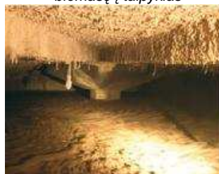
Bioreaktoriaus viduje substratai yra mikrobiologiškai skaidomi į metaną ir anglies dvideginį.
