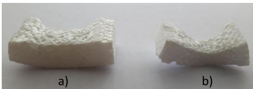
3.10 pav. PP nuotraukos po t = 60 s poveikio aukšta temperatūra ( 160 \pm 2,5 °C): a) PP su \text{SiO}_2 danga, b) PP be \text{SiO}_2 dangos
