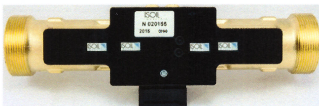
c) Šilumos skaitiklio q_p = 3,5/6 \text{ m}^3/\text{h} srauto jutiklis su srieginiu prijungimu G 1\frac{1}{4} B
