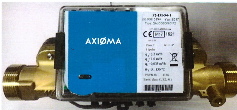
1 pav. Srauto jutiklis QALCASONIC F2 (matavimo ruožas ir elektronikos blokas)
