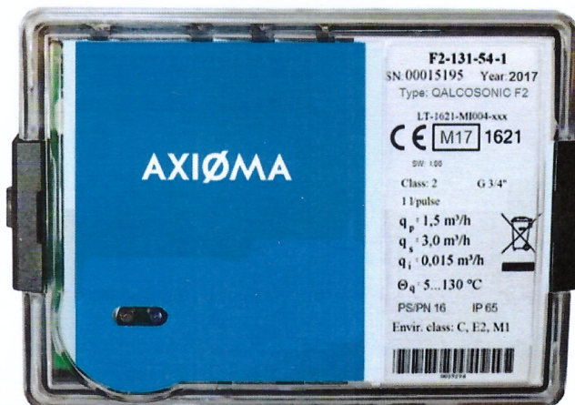
2 pav. Srauto jutiklio elektronikos blokas
