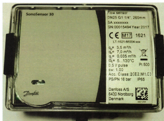
2 pav. Srauto jutiklio elektronikos blokas
