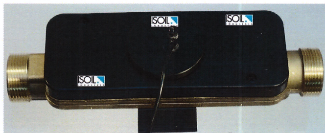
c) Šilumos skaitiklio IFX-M4-03 q_p = 3,5/6 \text{ m}^3/\text{h} srauto jutiklis su srieginiu prijungimu G 1\frac{1}{4} B
