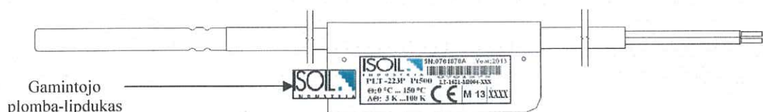
2 pav. Temperatūros jutiklių plombavimas gamintojo plomba-lipduku
