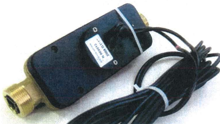
2 pav. Šilumos skaitiklio SKU-4 srauto jutiklis, q_p = 3,5/6 \text{ m}^3/\text{h}
