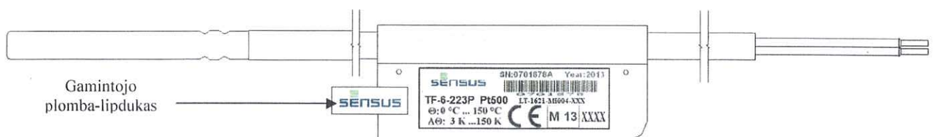
2 pav. Temperatūros jutiklių plombavimas gamintojo plomba-lipduku
