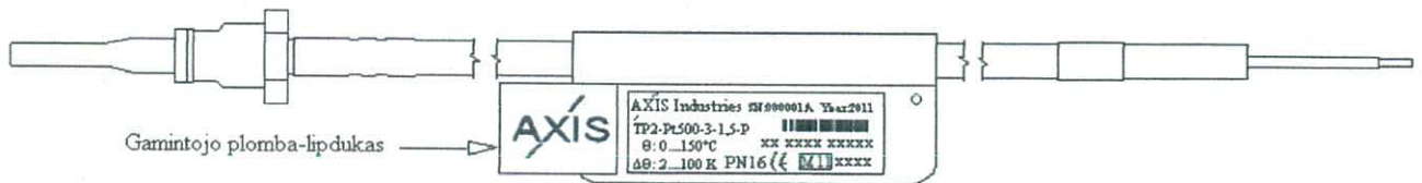
2 pav. Temperatūros jutiklių plombavimas gamintojo plomba-lipduku
