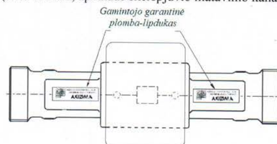
f) Vandens skaitiklio srauto jutiklio su prijungimu G2; DN40; DN50; DN65; DN80; DN100 plombavimas (IP68)
