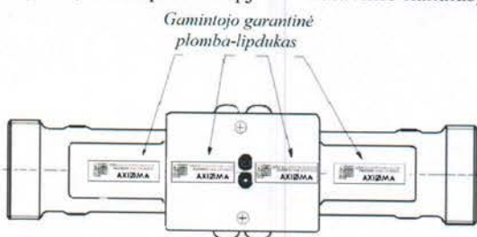
e) Vandens skaitiklio srauto jutiklio su prijungimu G2; DN40; DN50; DN65; DN80; DN100 plombavimas (IP65)
