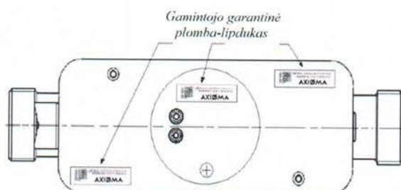
b) Vandens skaitiklio srauto jutiklio su prijungimu G1 \frac{1}{4} , G1 \frac{1}{2} , DN25, DN32 plombavimas (IP65, trikampio skerspjūvio matavimo kanalas)
