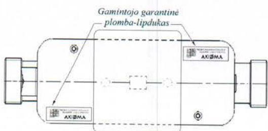
c) Vandens skaitiklio srauto jutiklio su prijungimu G1 \frac{1}{4} , G1 \frac{1}{2} , DN25, DN32 plombavimas (IP68, trikampio skerspjūvio matavimo kanalas)
