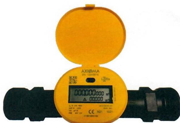
Fig. 3. Water meter QALCOSONIC W1,
