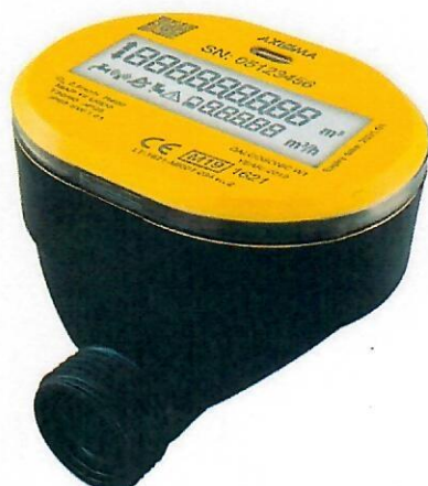
1 pav. Vandens skaitiklis QALCASONIC W1, Q_3 = 1,6 / 2,5 / 4,0 \text{ m}^3 , su srieginiu prijungimu G \frac{3}{4} arba G 1
