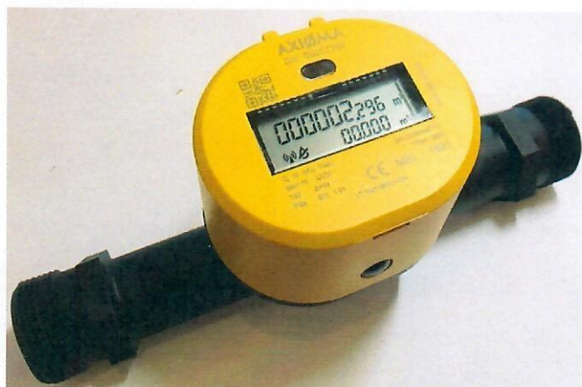
2 pav. Vandens skaitiklis QALCASONIC W1, Q_3 = 6,3 / 10 \text{ m}^3 , su srieginiu prijungimu G 1\frac{1}{4} arba G 1\frac{1}{2}
