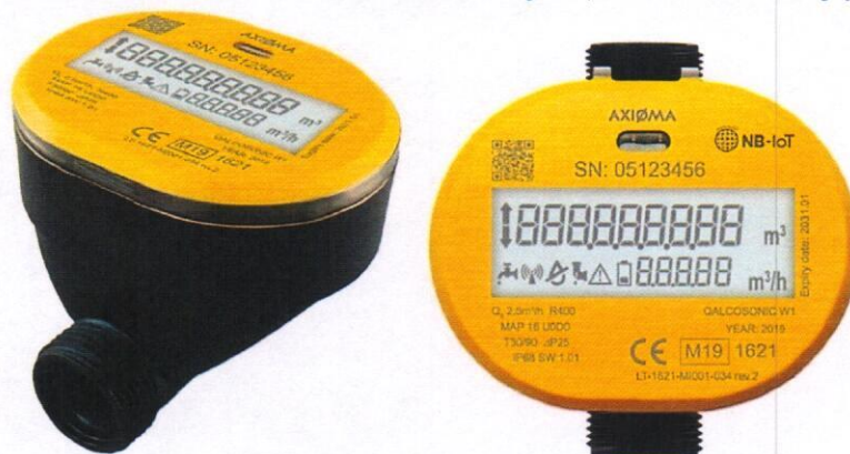
1 pav. Vandens skaitiklis QALCASONIC W1, Q_3 = 1,6/2,5/4,0 \text{ m}^3/\text{h} , su srieginiu prijungimu G \frac{3}{4} arba G 1 (skaitiklio dizainas pirminės versijos)
