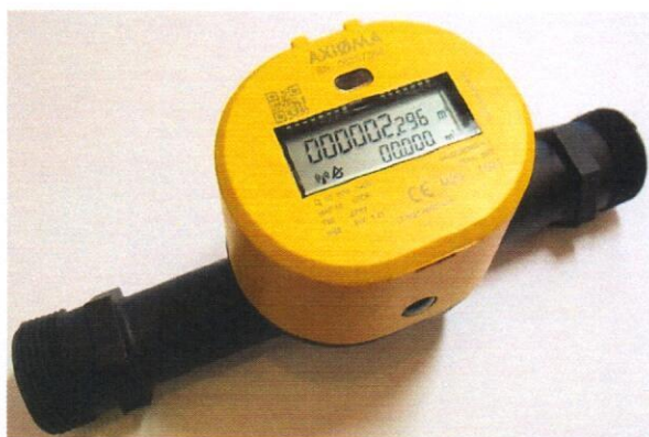
3 pav. Vandens skaitiklis QALCOSONIC W1, Q_3 = 6,3/10 \text{ m}^3 , su srieginiu prijungimu G 1 1/4 arba G 1 1/2
