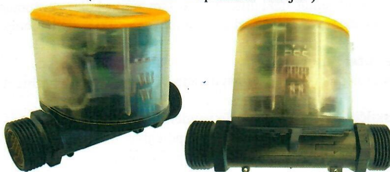
2 pav. Vandens skaitiklis QALCOSONIC W1, Q_3 = 1,6/2,5/4,0 \text{ m}^3/\text{h} , su srieginiu prijungimu G ¾ arba G 1 (skaitiklio dizainas versijos „n“)
