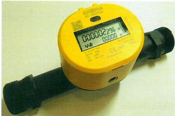
3 pav. Vandens skaitiklis QALCASONIC W1, Q_3 = 6,3/10 \text{ m}^3 , su srieginiu prijungimu G 1¼ arba G 1½
