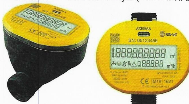
1 pav. Vandens skaitiklis QALCASONIC W1, Q_3 = 1,6/2,5/4,0 \text{ m}^3/\text{h} , su srieginiu prijungimu G ¾ arba G 1 (skaitiklio dizainas pirminės versijos)
