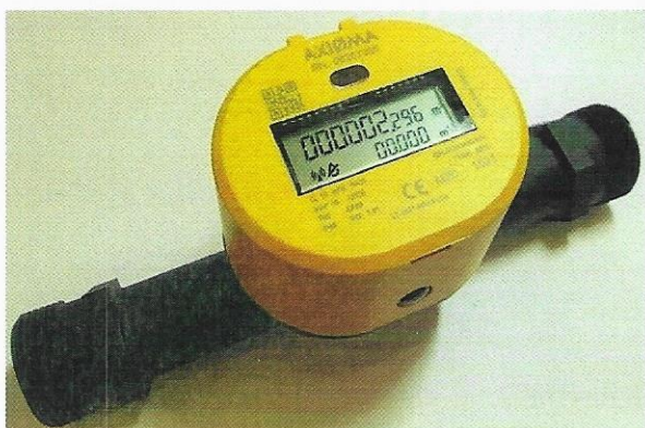
3 pav. Vandens skaitiklis QALCOSONIC W1, Q_3 = 6,3/10 \text{ m}^3 , su srieginiu prijungimu G 1\frac{1}{4} arba G 1\frac{1}{2}
