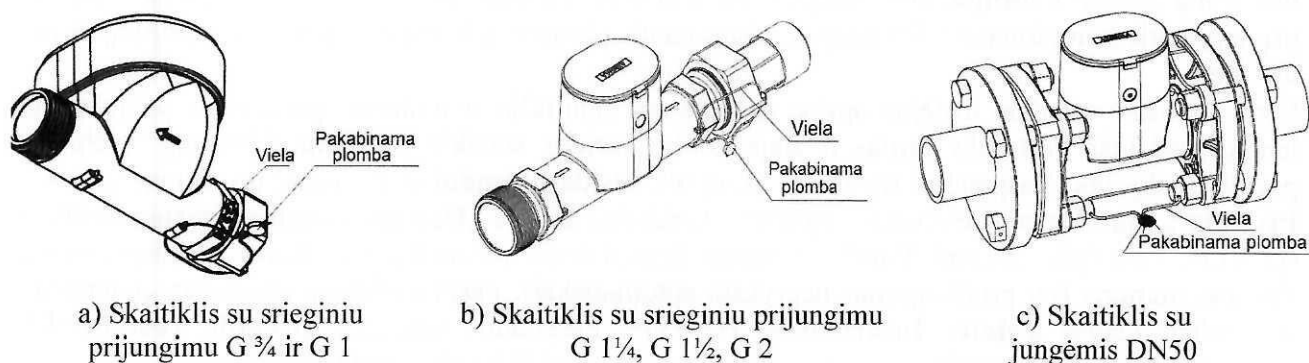
6 pav. Vandens skaitiklio QALCOSONIC W1 plombavimas po įrengimo
