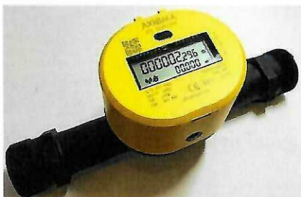
2 pav. Vandens skaitiklis QALCASONIC W1, Q_3 = 6,3/10 \text{ m}^3 , su srieginiu prijungimu G 1¼ arba G 1½
