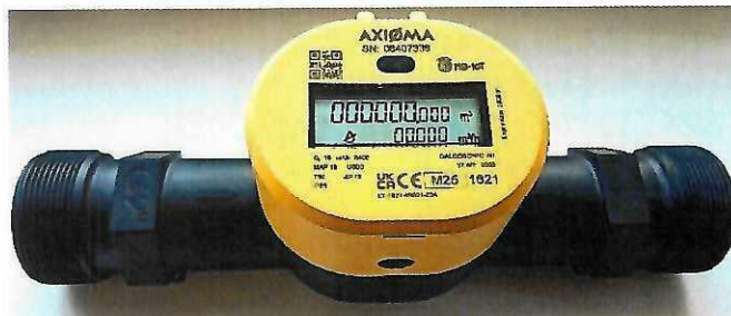
5 pav. Vandens skaitiklis QALCASONIC W1, Q_3 = 10/16/25 \text{ m}^3 , su srieginiu prijungimu G 2
