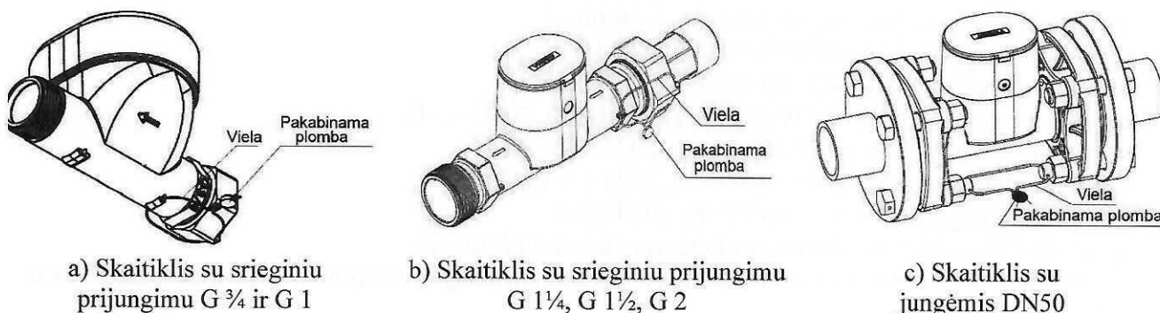
5 pav. Vandens skaitiklio QALCOSONIC W1 plombavimas po įrengimo
