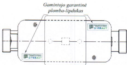
c) Vandens skaitiklio srauto jutiklio su prijungimu G \frac{1}{4} , G \frac{1}{2} , DN25, DN32 plombavimas (IP68, trikampio skerspjuvio matavimo kanalas)
