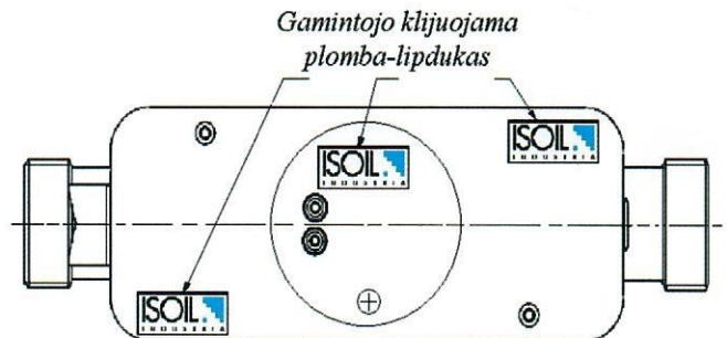
7 pav. Srauto jutiklio matavimo ruožo q_p = 3,5/6,0 \text{ m}^3/\text{h} plombavimas
