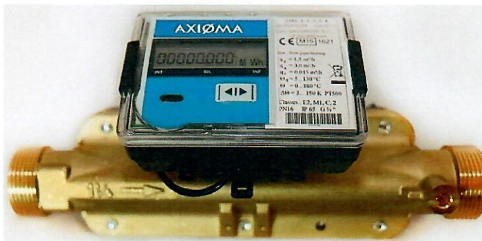
1 pav. Šilumos skaitiklis QALCOSONIC E1 (skaičiuotuvas ir srauto jutiklis)
