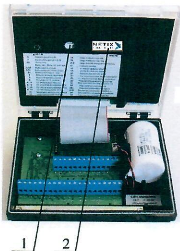
3 pav. Šilumos energijos skaitiklio skaičiuotuvo plombavimas
