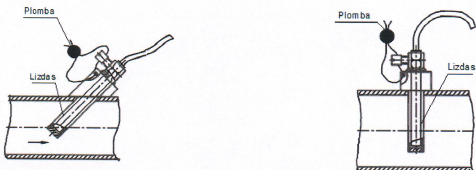
7 pav. PL tipo temperatūros zondu plombavimas
