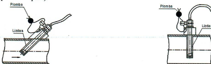
9 pav. PL tipo temperatūros zondu plombavimas
