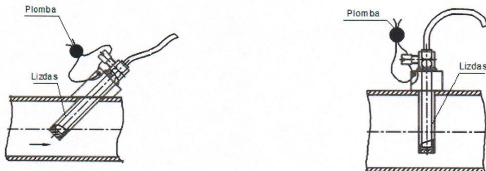
7 pav. PL tipo temperatūros zondų plombavimas
