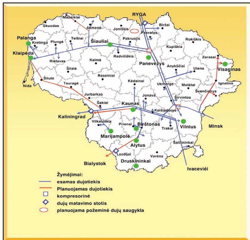
7.1 pav. Lietuvos dujų tiekimo sistemos perspektyvinė tinklų schema
