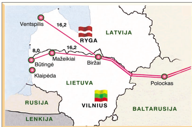
8.1 pav. Lietuvos naftos tiekimo sistemos schema
