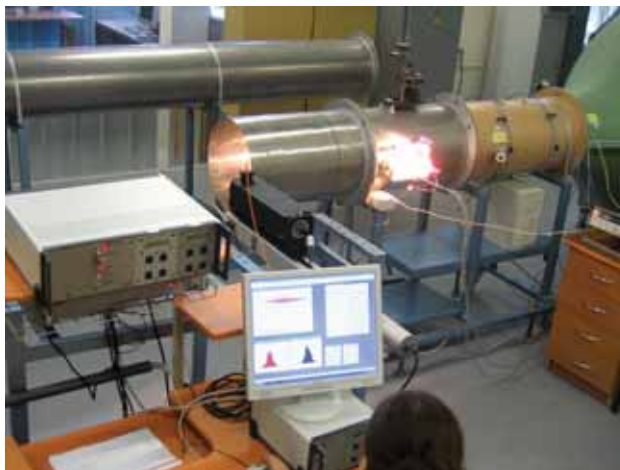
Įrenginys oro greičio matavimo tyrimams taikant LDA
