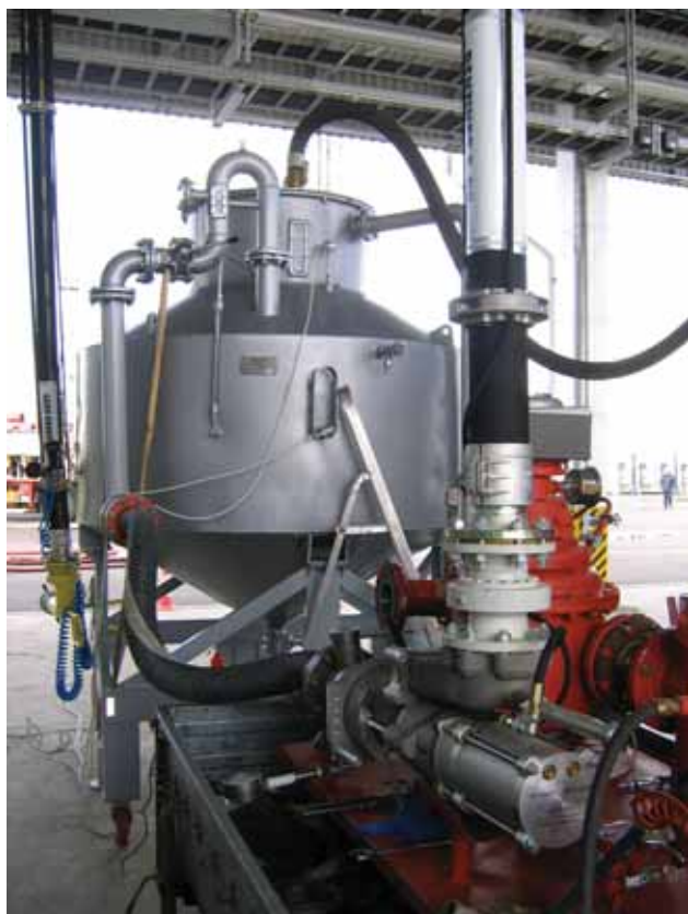
Mobilus įrenginys su 5 m 3 saikikliu ir kameriniais skaitikliais
