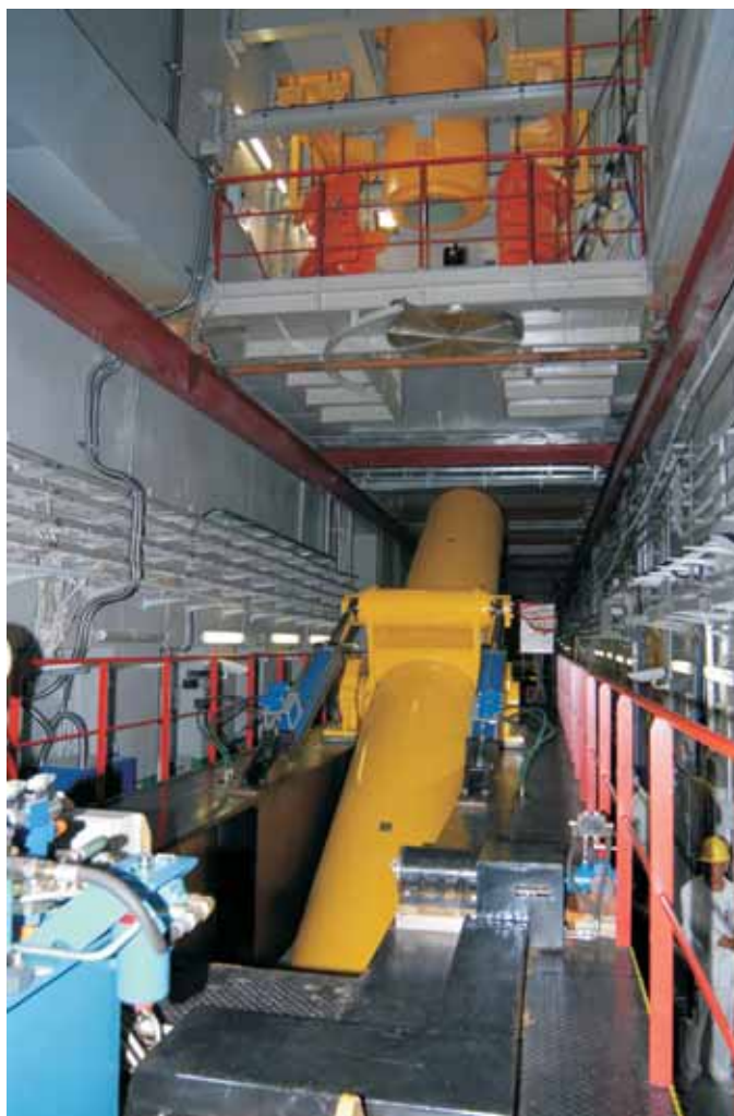
Bandymų metu konteineris pasukamas iš horizontalios padėties į vertikalią
