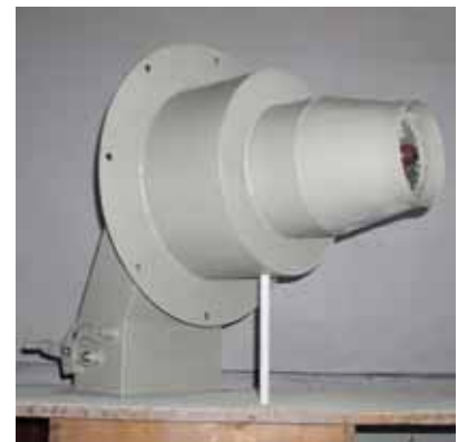
Naujos degiklių konstrukcijos anglies monoksido išdeginimui: kairėje – mazuto kuro degiklis atliekų krosnims; dešinėje – dujų kuro degiklis medienos katilui
