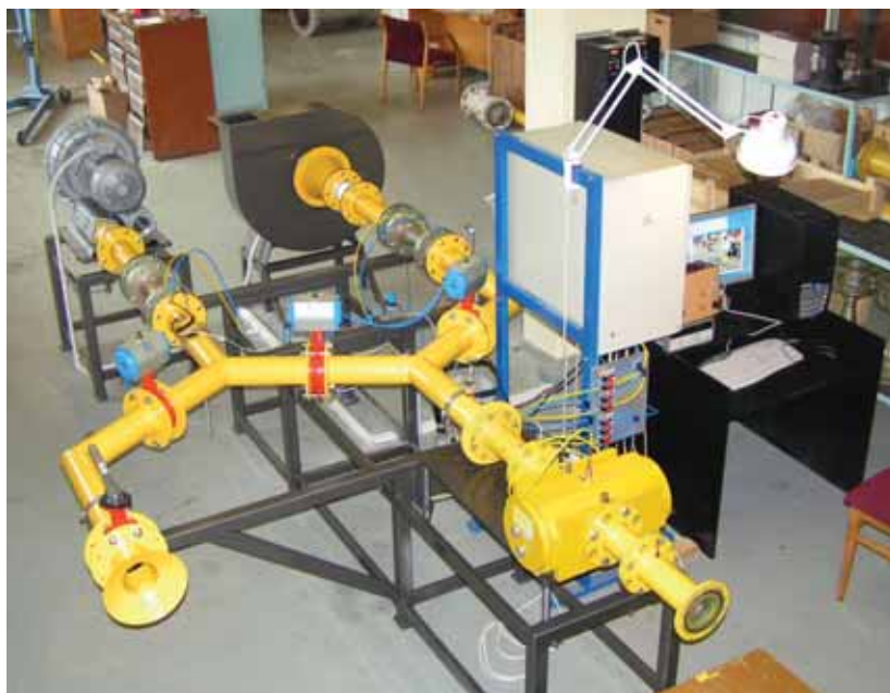
Turbininių dujų skaitiklių tyrimo įrenginys, debitams iki 1000 m 3 /h
