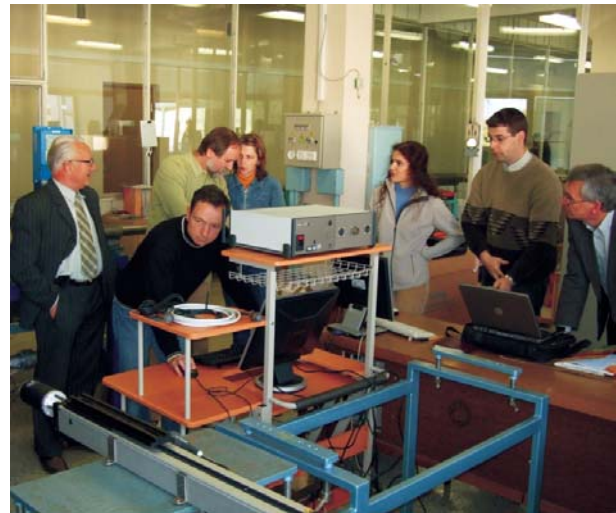
LDA bandymai laboratorijos hidrodinamiame įrenginyje dalyvaujant Vokietijos ILA GmbH firmos gamintojos atstovui M.Dues
