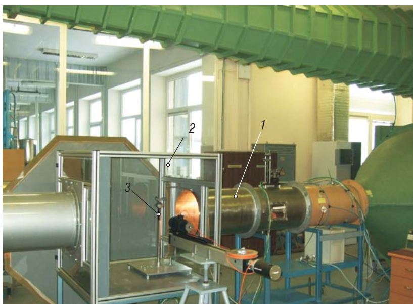
2009 m. rekonstruotas aerodinaminio įrenginio matavimo kanalas greičio matavimams pradiniam kanalo ruože ir laisvoje srovėje, įtekančioje į apsauginę kamerą: 1 – matavimo kanalas; 2 – apsauginė kamera; 3 – tiriamasis objektas – vėjo greičio matuoklis
