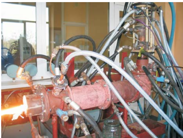
Medžiagų lydymas plazmocheminiame reaktoriuje (kairėje) ir aukštatemperatūriame tiglyje (dešinėje)
