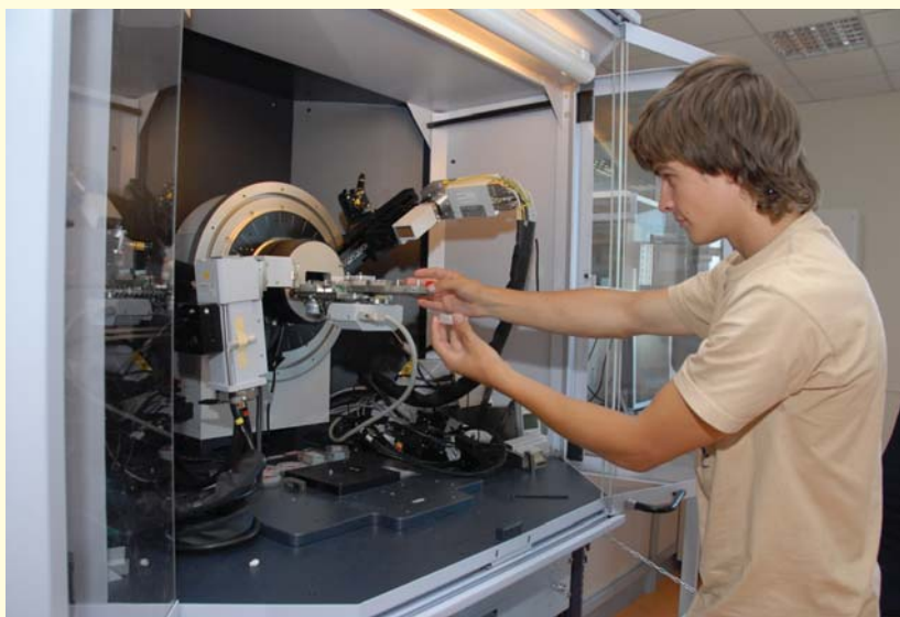
Bruker D8 Discover (Vokietija) rentgeno spindulių difraktometras su priedais leidžiančiais atlikti sintezuotų medžiagų, plonų dangų ar nanomiltelių formoje, kristalinės struktūros analizę
