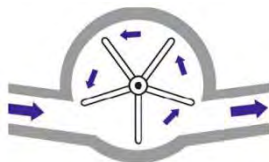
2 pav. Vienasrovio vandens skaitiklio schema
