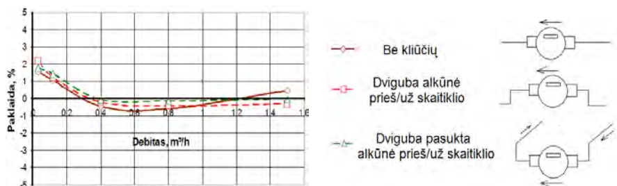
4 pav. Skaitiklio VS 30-1,5, l = 110 \text{ mm} , su didesne matavimo kamera, bandymų rezultatai
