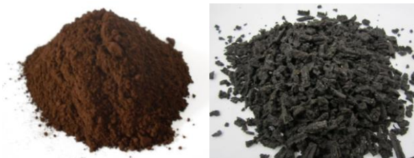
1 pav. Užterštos biomasės rūšys: kairėje pusėje ligninas, dešinėje – džiovintas ir granuluotas nuotekų dumblas
