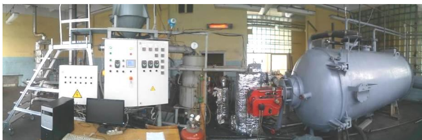
1 pav. Sausinto vandenvals nuotėkų dumblo dujinimo įrenginio schema ir nuotrauka
