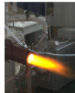
Плазматрон водяного пара для обработки органических отходов
