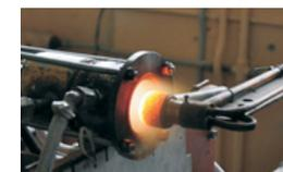
Исследование поведения тугоплавких материалов в высокотемпературной зоне
