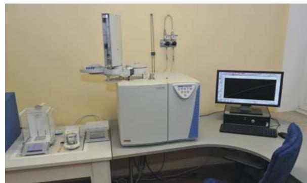
6 pav. Kuro elementų analizatorius Flash 2000 pagrindinių cheminių elementų C/H/N/S ir O analizei
