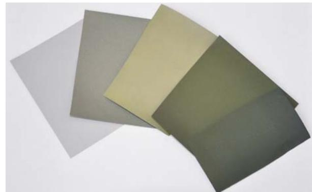
*Konstrukcinių medžiagų paviršinių sluoksnių formavimas atmosferos slėgio oro plazmoje ir paruoštų produktų pavyzdžiai*
