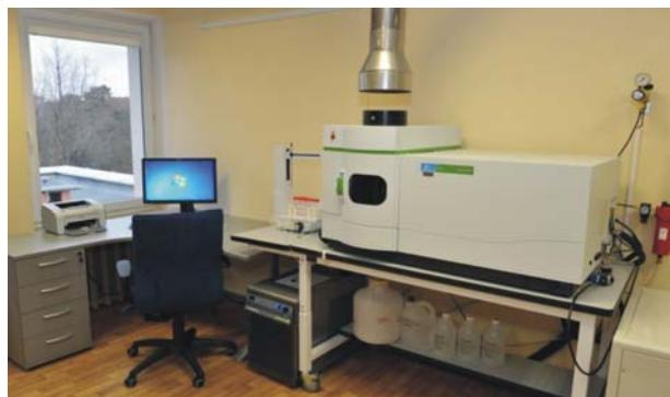
5 pav. ICP-OES (Indukuotos plazmos optinis emisinis spektrometas) biokuro ir atgautojo kuro elementinės sudėties tyrimams
