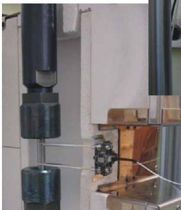
mo siūlių elgseną dėl valkšumo-nuvargio procesų aukštose temperatūrose, svarbūs prognozuojant jų ilgaamžiškumą reaktoriaus komponentuose, bei suvirinimo technologijų tinkamumo įvertinimui, vykdant tolesnius suvirinimo medžiagų bei eksplatacinį veiksnį sukeliamų procesų branduoliniuose komponentuose tyrimus.
