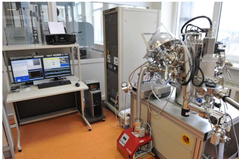
*ULVAC-PHI rentgeno spindulių fotoelektroninės spektroskopijos įrenginys (standartinis trumpinimas XPS arba ESCA) Versaprobe 5000*
