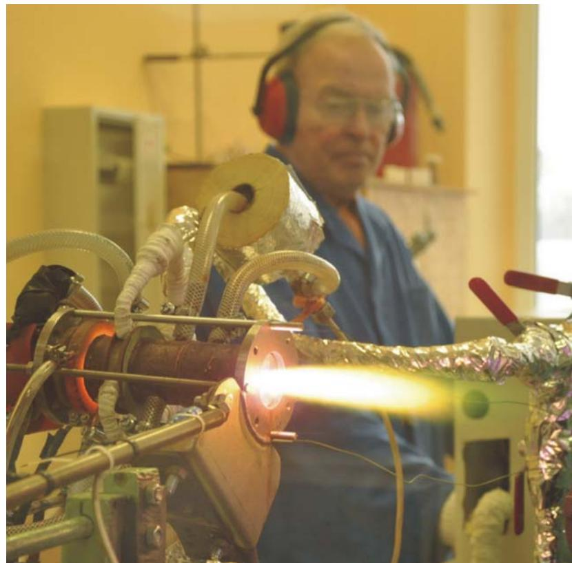
Vandens garo plazmos srovė, ištekanti iš 35 kW galios plazmos generatoriaus anodo
