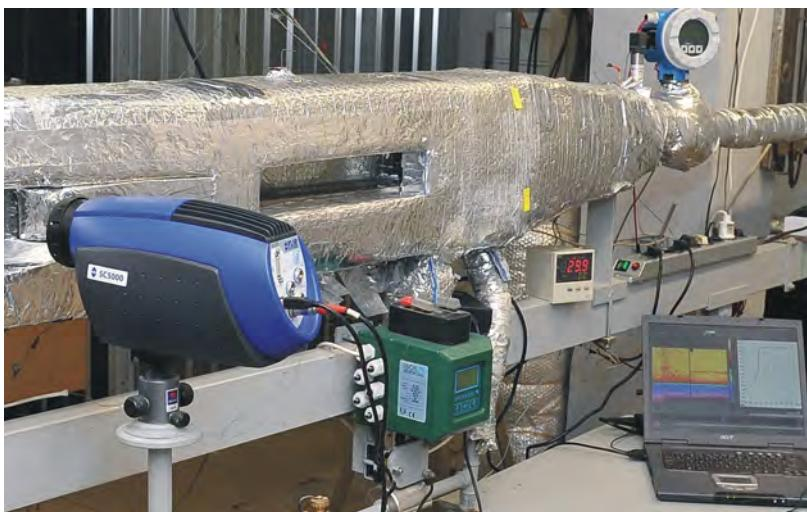
*Temperatūros lauko matavimas IR radiometrijos metodu*
