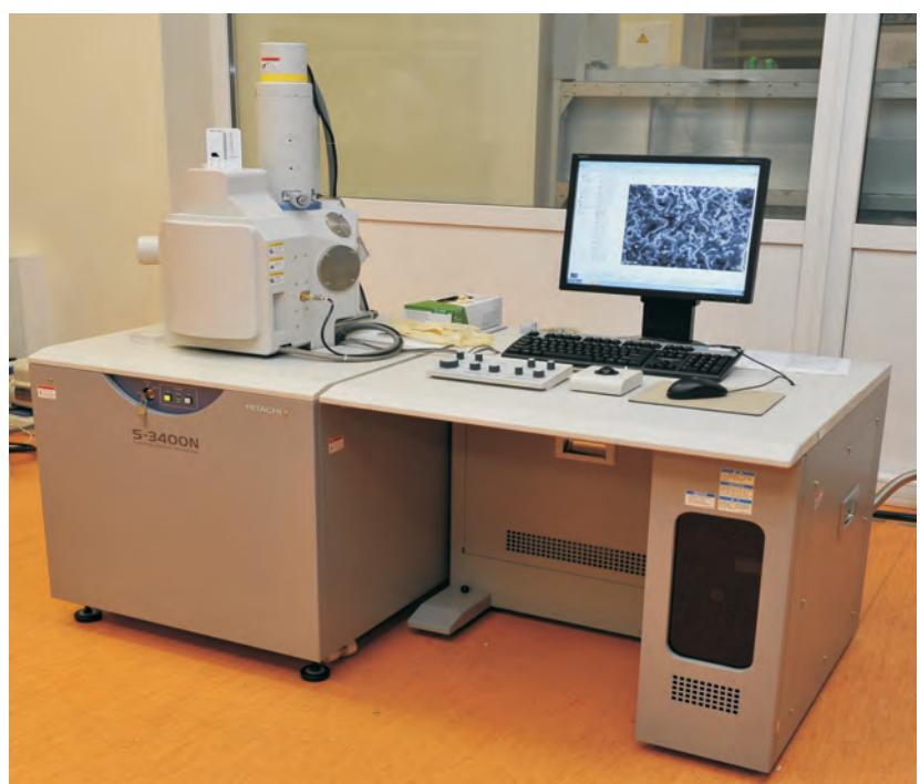
*2 pav. HITACHI S-3400N skenuojantis elektroninis mikroskopas*
