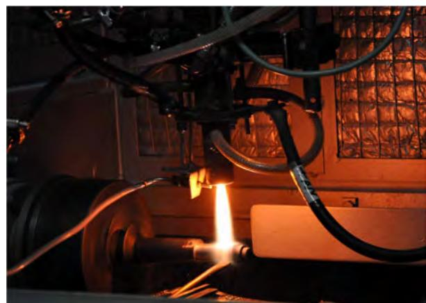
13 pav. Įvairių metalų, metalų oksidų dangų formavimas atmosferos slėgio oro plazmoje
