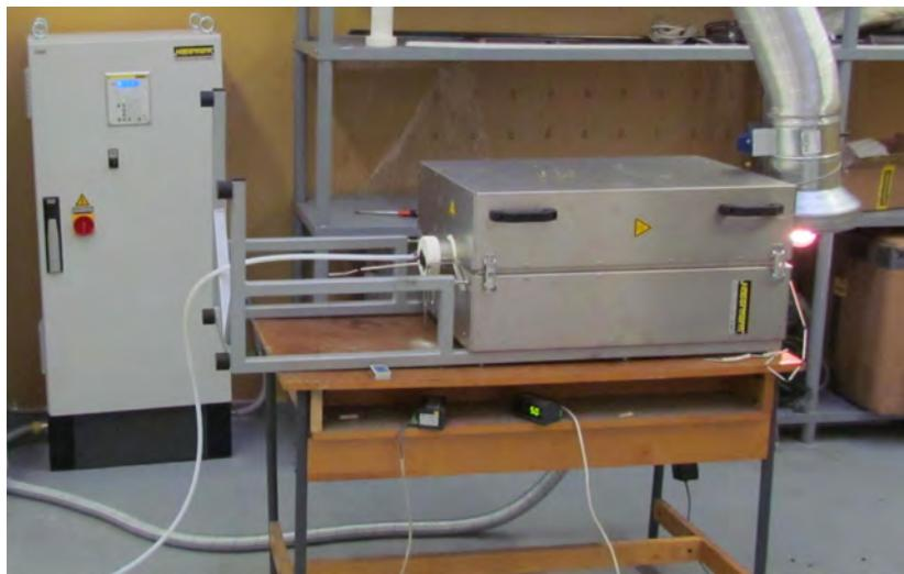
Vamzdinė elektrinė krosnelė Nobertherm RS 80/500/13 su temperatūros valdymo bloku
