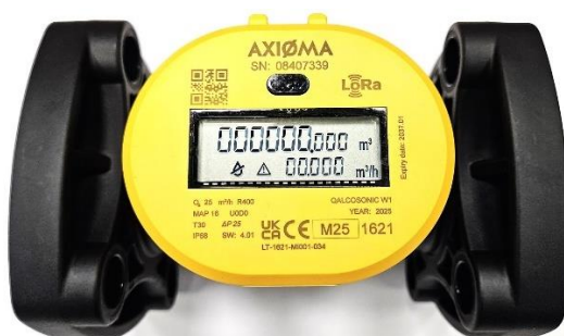
6 pav. Vandens skaitiklis QALCASONIC W1, Q_3 = 16/25/40 \text{ m}^3 , su jungėmis DN50
