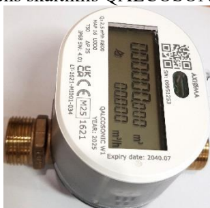
2 pav. Vandens skaitiklis QALCOSONIC W1, Q_3 = 1,6/2,5 \text{ m}^3/\text{h} , G \frac{3}{4} , su žalvario korpusu
